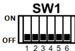
Rys.3. Mikroprzełącznik SW1 pozwalający na wybór wartości adresu szątkowego z zakresu od 0 do 7.
